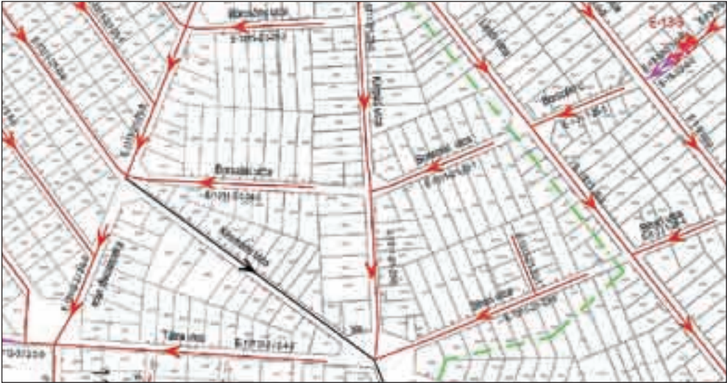
Térképrészlet az épülő csatornahálózatról. Jelmagyarázat: piros nyíl épülő csatorna lejtési iránya, a befogadók jelzése; fekete - már meglévő csatorna; zöld - a vízgyűjtő terület határa
