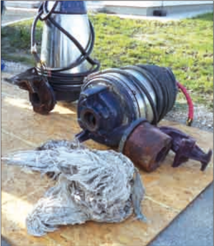
Rögtönzött kiállítás a csatornába dobált, majd a karbantartás alatt kiemelt, nemezes masszává összeállt tárgyakból – ezek, pontosabban a gondatlan használók miatt leállhatnak a szivattyúk
