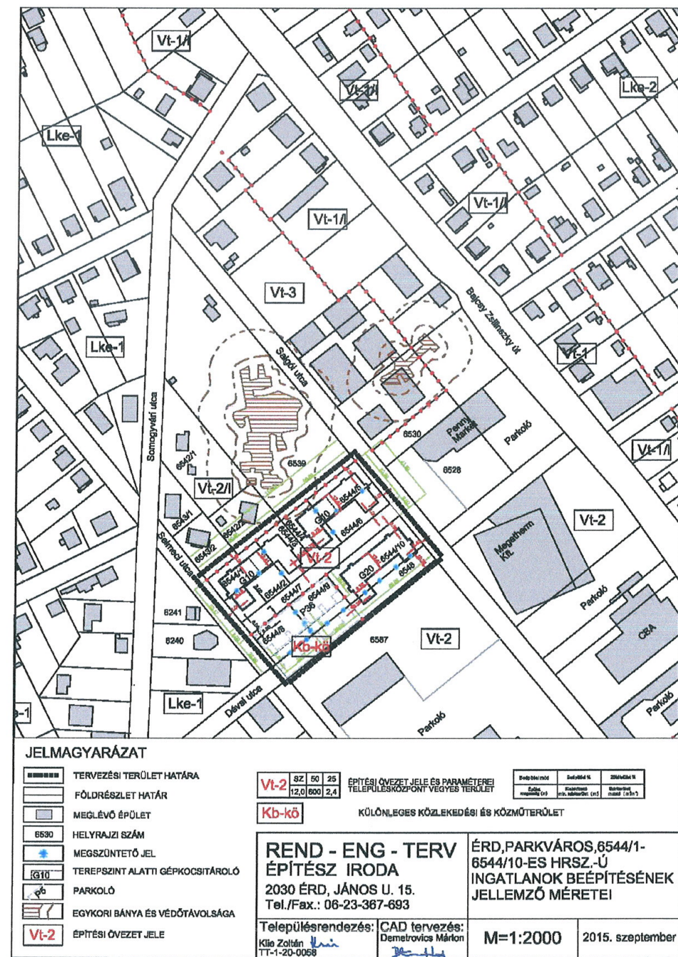
4. számú melléklet: A beépítés jellemző méretei M=1:1000
