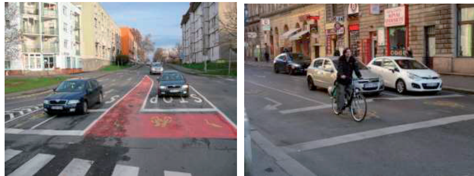
86. ábra Előretolt kerékpáros felállóhely rávezető kerékpársávval (Kaposvár) és sáv nélkül, kerékpáros nyomokkal (Budapest)
