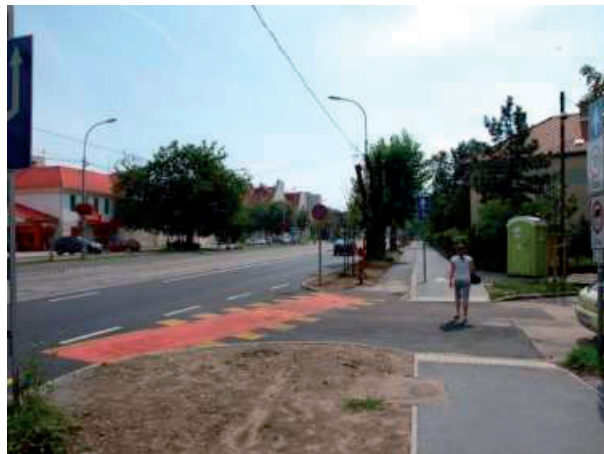
74. ábra – Kerékpársáv és egyirányú (gyalog- és) kerékpárút csatlakozása (Budapest)
