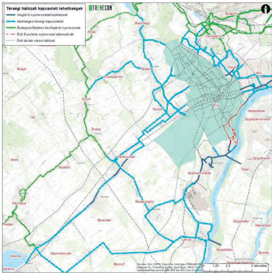
96. ábra – Az érdi városi hálózat külső kapcsolati lehetőségei, egy távlati térségi hálózati, mely elsősorban a szabadidős kerékpározás fejlesztését célozza
