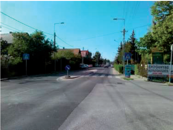
97. ábra – Balatoni úti gyalogátkelő a Sárd utcánál, a forgalom sebességét és az átkelést is szolgáló középszigettel
