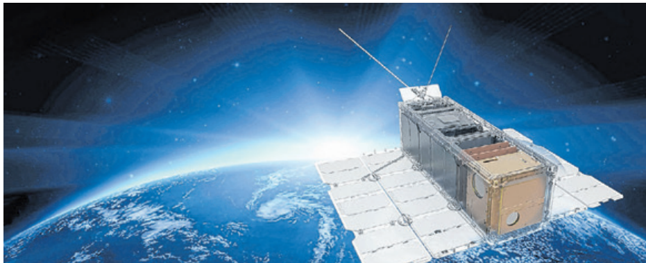
A Magyarországon készülő RadCube egy háromegységes CubeSat osztlályú műhold lesz kinyitható napelemtáblákkal és antennákkal
