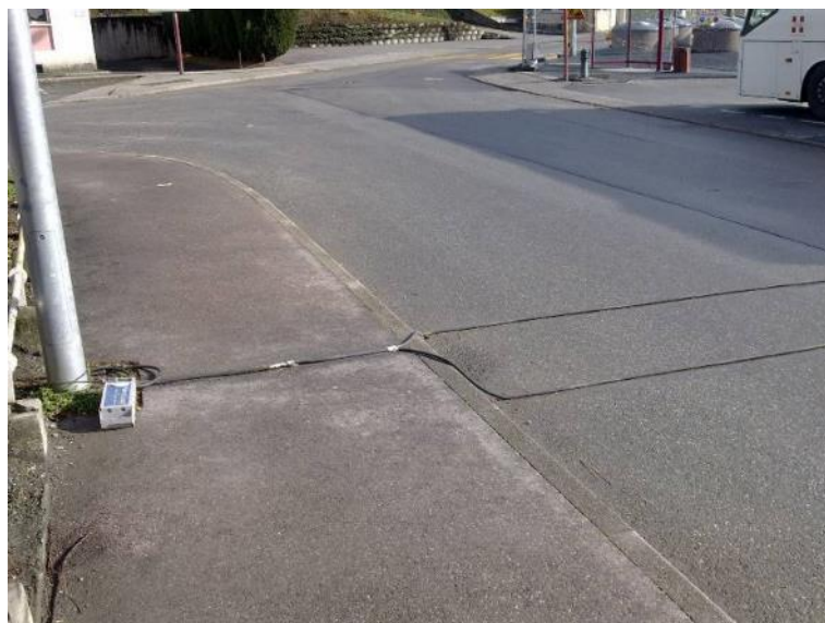
140. ábra – Mobil forgalomszámláló berendezés
