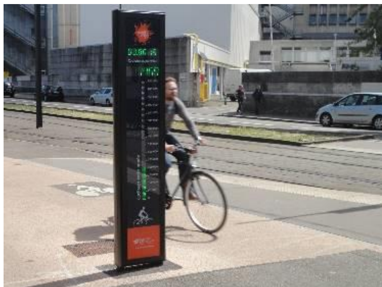
143. ábra – Kerékpáros forgalomszámláló kijelző (Nantes)
